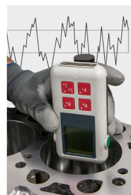
O rugosímetro permite aferir a rugosidade da superfície de forma eficaz e conclusiva. Graças à distribuição e acentuação das estrias e picos (topografia) no documento relativo à rugosidade é possível avaliar como a superfície evolui durante a rodagem, quanto volume de retenção de óleo oferece e qual será a percentagem da área de contacto. Além disso, o documento relativo à rugosidade é uma documentação valiosa da qualidade do brunimento.
