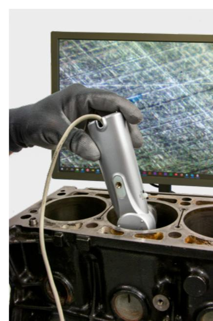
As estruturas da superfície podem ser também avaliadas visualmente através de imagens de microscópio. A partir de uma ampliação de 200x, o ângulo de brunimento, a profundidade das estrias e a desobstrução dos cristais de silício podem ser avaliados mais facilmente. Tornam-se visíveis os depósitos de sujidade ou formações indesejadas de um revestimento de aço.
